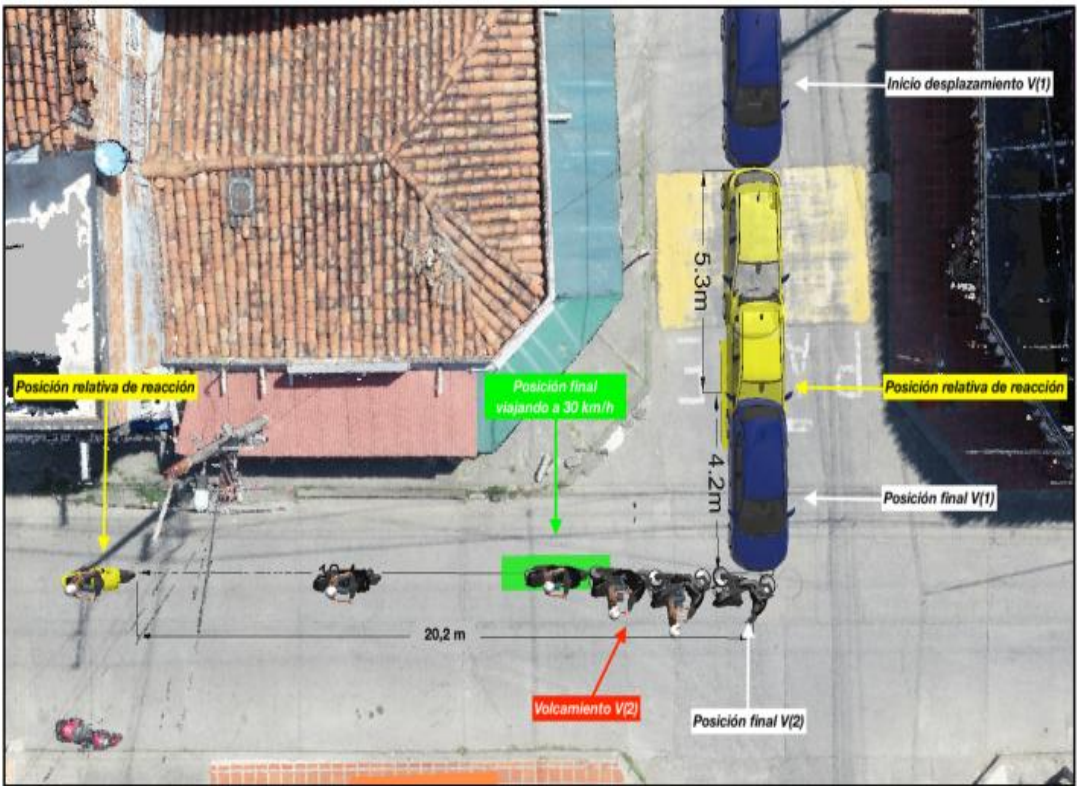
Imagen 30. Vista cenital de la dinámica del accidente, se señalan las posiciones relativas del momento en que la conductora percibe a la motociclista y viceversa, cabe anotar que la posición en color verde es la posición final si ésta última hubiera viajado a 30 km/h, permitiendo deducir que la velocidad de la motocicleta era superior a la reglamentaria.
