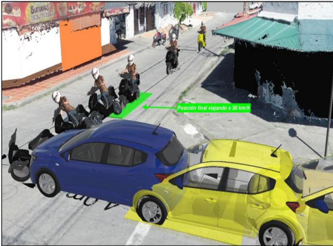
Imagen 33. Correlación de las posiciones del automóvil frente a la motocicleta, el escenario coincide con posiciones de reacción para ambos participantes y desplazamientos después de ejecutar sus respectivas maniobras de frenado, para obtener las posiciones finales registradas, sin colisión entre los vehículos.
