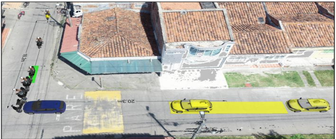
Imagen 37. Reconstrucción de las posiciones de la dinámica del accidente según las condiciones del segundo escenario, se observa que la conductora del automóvil no tuvo capacidad visual de observar a la motociclista, por lo que atendiendo a la lógica, hubiera mantenido su velocidad constante sin reducirla e impactando la motocicleta.
