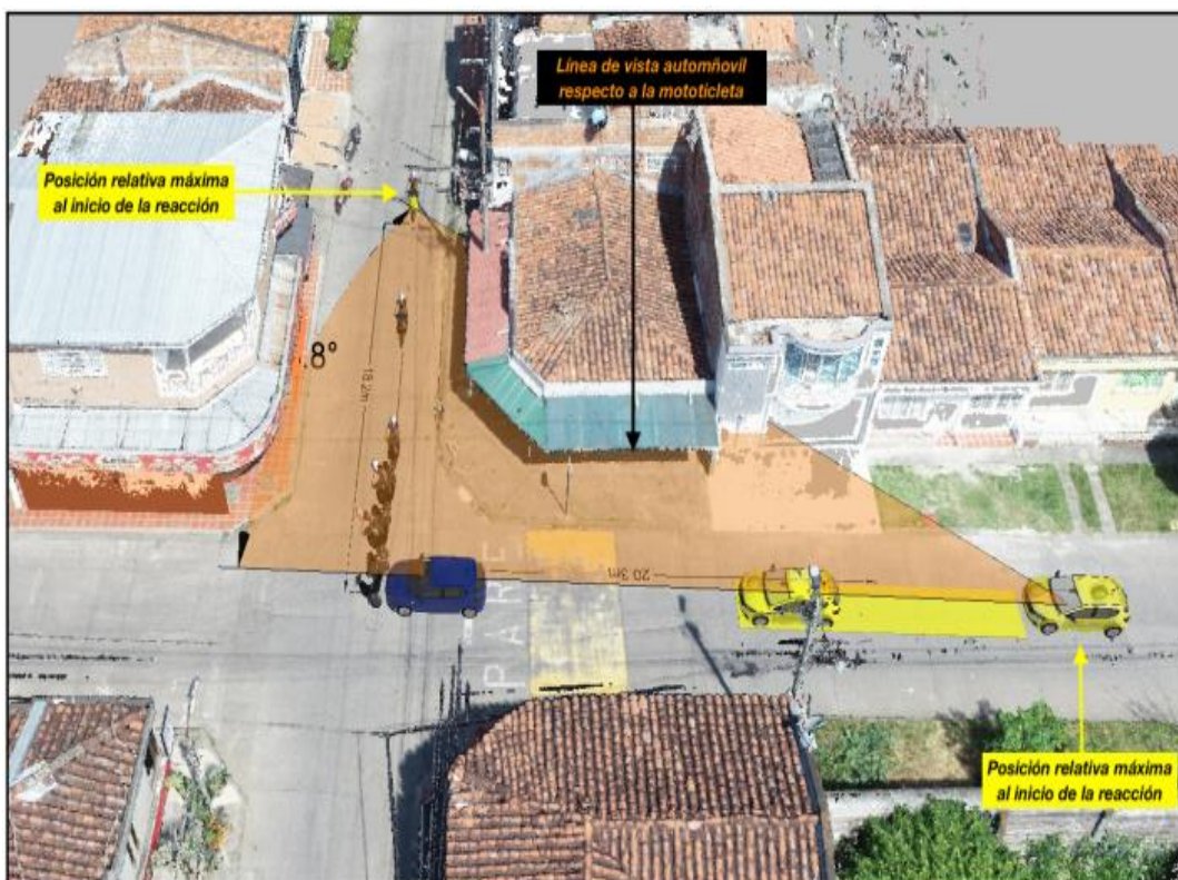
Imagen 35. Reconstrucción de las posiciones relativas presentadas en el segundo escenario, se observa en color naranja que la línea de vista de la conductora esta siendo afectada por las edificaciones, por lo que no sería posible una reacción frente a una peligro inminente que le obligara a reducir la velocidad, igualmente para la motocicleta.
