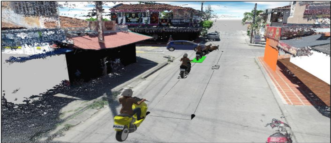
Imagen 38. Reconstrucción de las posiciones de la dinámica del accidente según las condiciones del segundo escenario, se observa que la conductora de la motocicleta, viajando a velocidad constante, no lograría percibir al automóvil ya que no se tiene línea visual con este, a causa de los edificios, por lo que la motociclista no hubiera reaccionado frenando su motocicleta.
