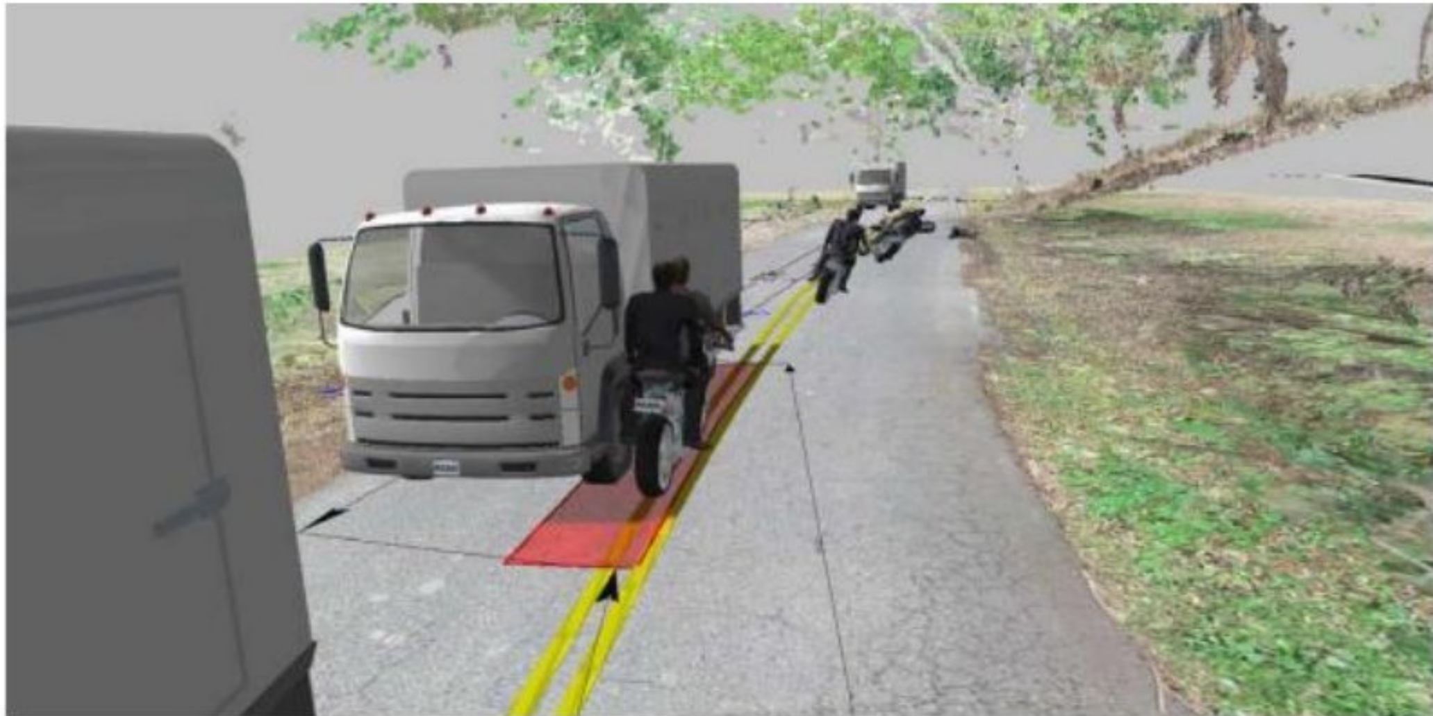
Figura 39. Reconstrucción posición de los vehículos durante el impacto entre el miembro superior izquierdo del conductor de la motocicleta y el vértice anterior izquierdo de la carrocería del camión.
