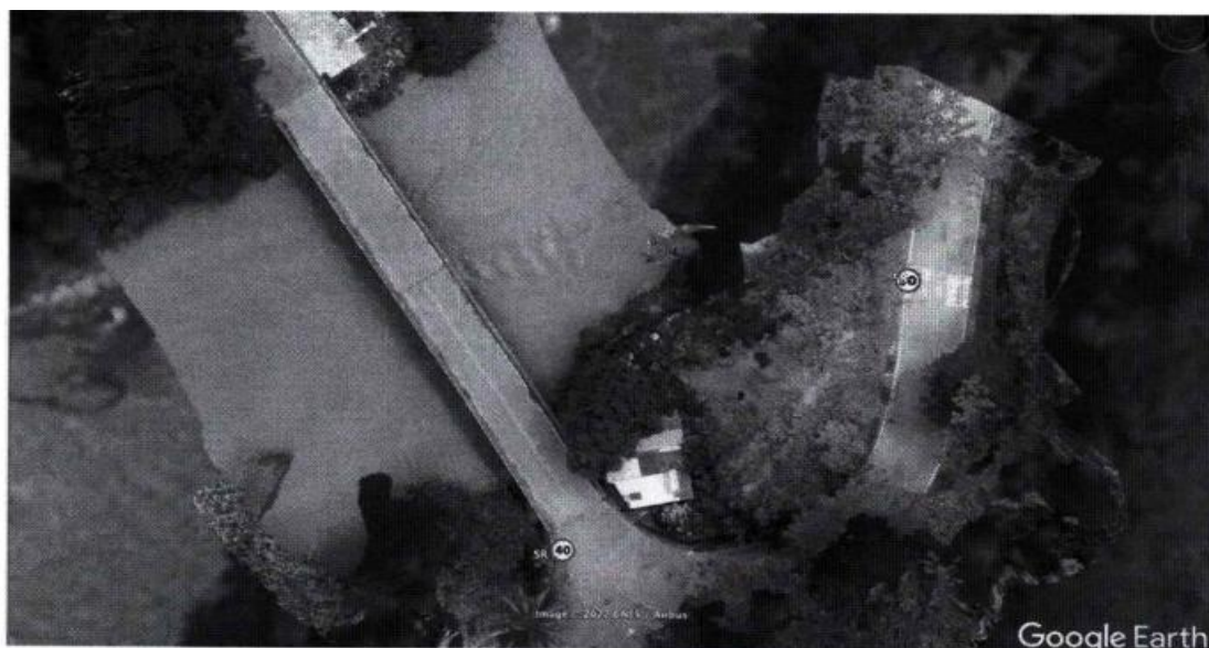
Figura 4. Plano cenital reconstrucción del lugar de los hechos, en el cual se integra la imagen satelital de Google Earth y el ortomosaico realizado por el suscrito perito, con el fin de ilustrar la geometría vial de acuerdo con la trayectoria de cada vehículo y la señalización vertical de velocidad máxima permitida en el sector de 30 km/h con fecha octubre 2014 en el sentido de circulación de la motocicleta, y 40 km/h para el vehículo tipo camión.
